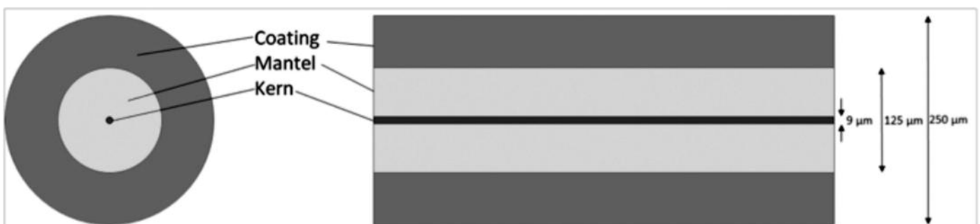
Aufbau eines Glasfaserkabels (Single-Mode)
